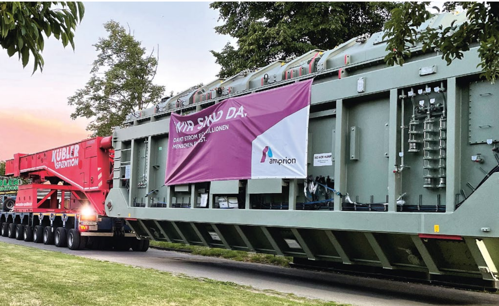
Transport von einem Transformator zur Umspannanlage
