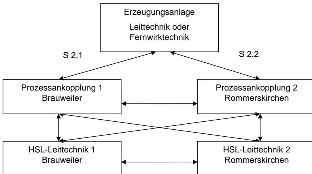
Bild 1: Variante 1, Fernwirktechnisches System in einfacher Auslegung in der Erzeugungsanlage
