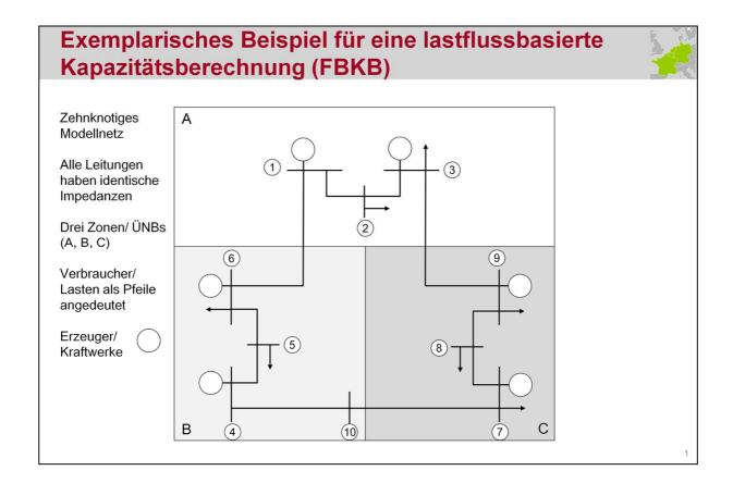
Das dargestellte zehnknotige Modellnetz wird genutzt, um die CWE Flow-Based Kapazitätsberechung (FBKB) zu erläutern.
