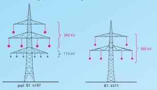
Zuerst werden die Masten für die neue 110-/380-kV-Leitung errichtet. Auf den oberen Querträgern werden die 380-kV- und darunter die 110-kV-Leiterseile aufgelegt. Danach kann die alte 220-kV-Leitung abgeschaltet und vollständig abgebaut werden. Dadurch verringert sich die Trassenbreite um bis zu 15 Metern.
