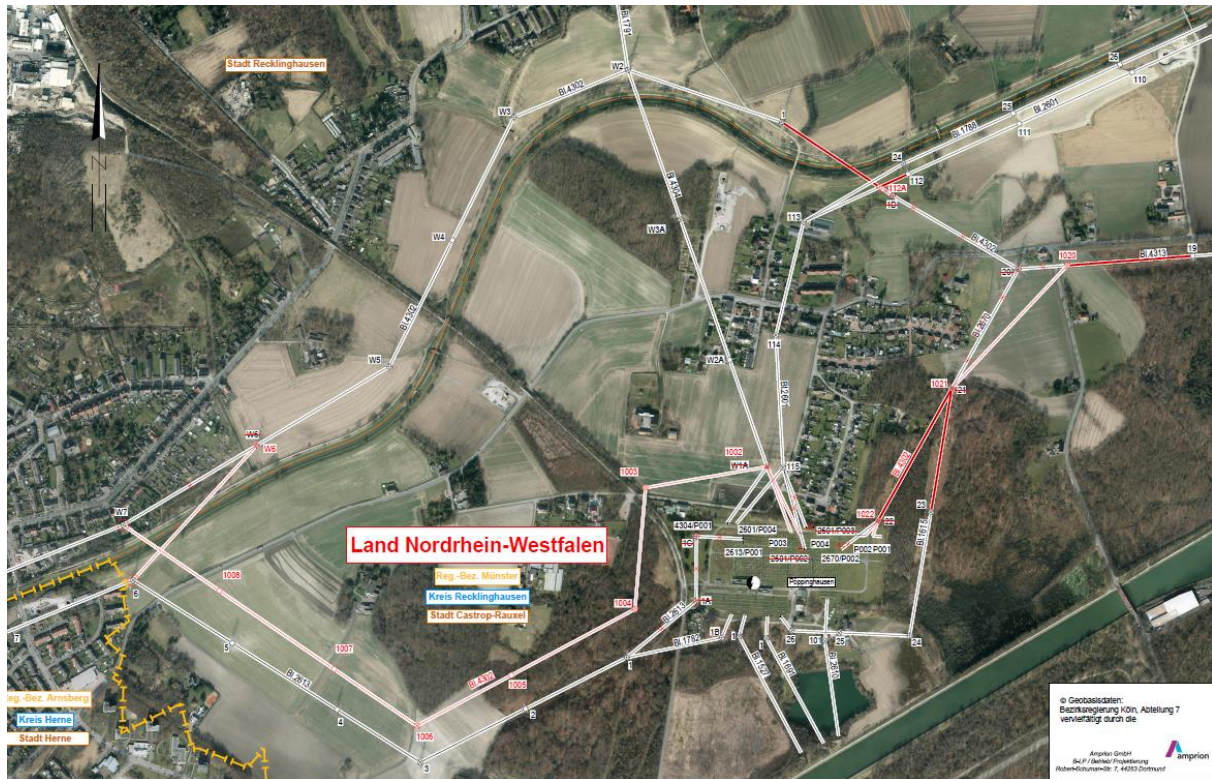
Abbildung 6: Darstellung der alternativen südwestlichen Parallelführung von zwei 380-kV-Stromkreisen
