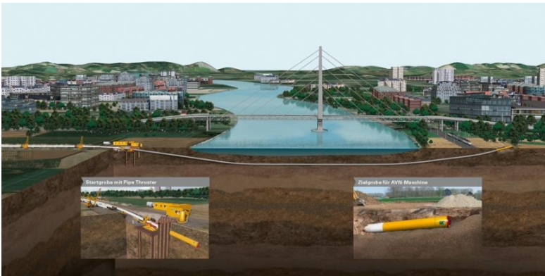
Abbildung 3-14: Direct-Pipe-Verfahren (Quelle: Herrenknecht AG)
