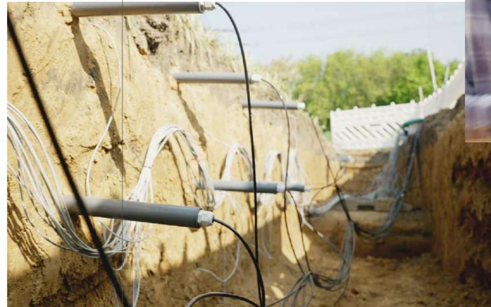
ABB. 35 LINKS Messsonden zur Bodenfeuchte- und Temperaturüberwachung
