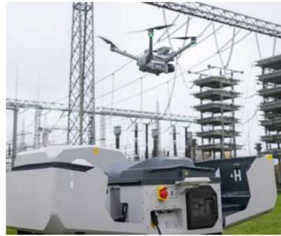
ABB. 35 Amprion-Drohne verlässt die Dockingstation zur Flugmission
